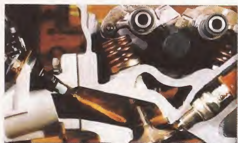
Funcionamiento de inyección visto en corte
